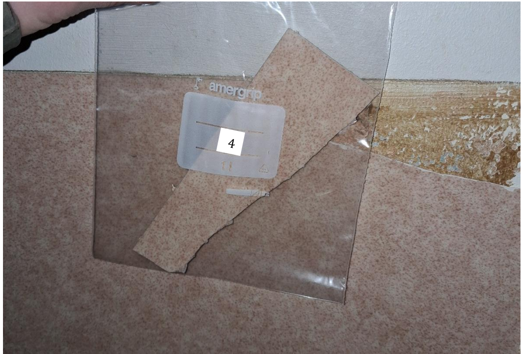
Kuva 8. Seinän muovitapetti beige + liima + maali (näyte 4) eivät sisällä asbestia.
