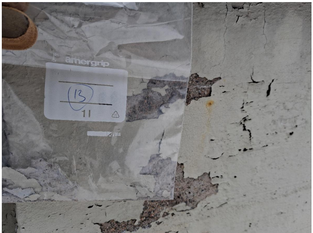
Kuva 15. Sokkelin maalit harmaa + vihertävä (näyte 13) eivät sisällä asbestia.
