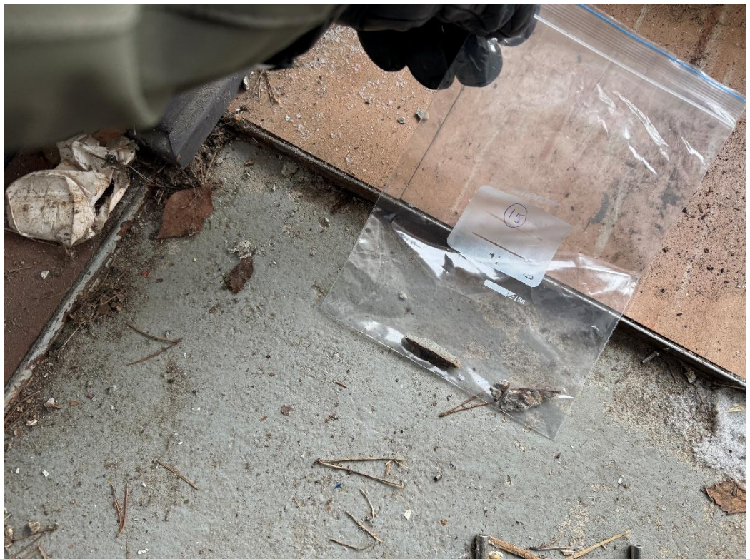
Kuva 17. Harmaa lattiamaa (näyte 15) ei sisällä asbestia.
