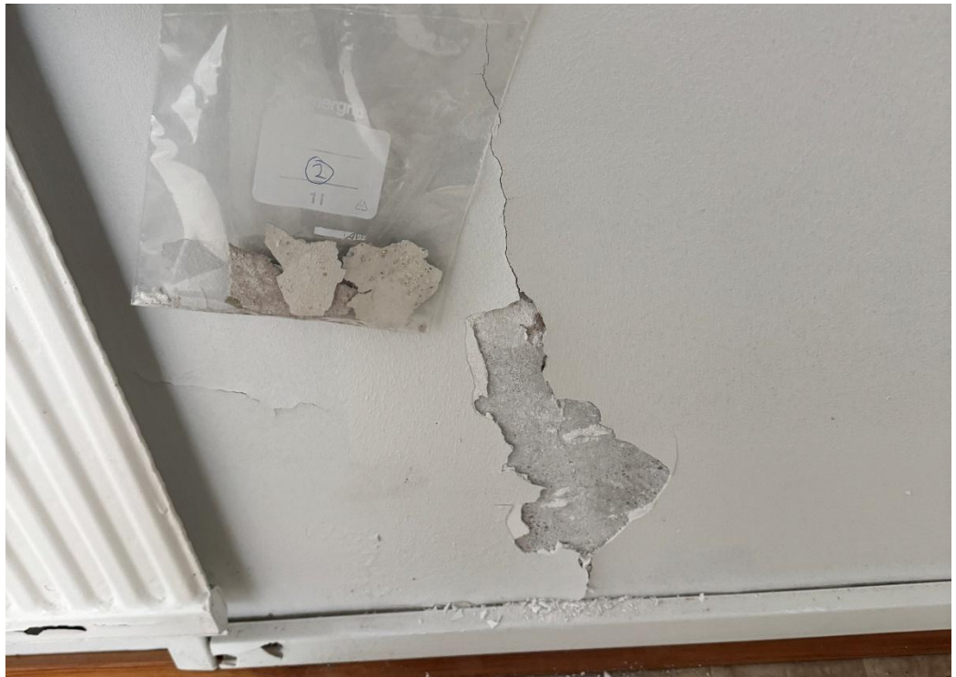
Kuva 6. Seinätasoite + maalit (koonti) (näyte 2) eivät sisällä asbestia.
