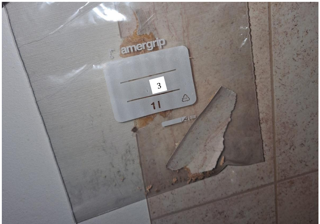
Kuva 7. Seinän muovitapetti laattakuvioitu vaalea ruskea + liima + maali (näyte 3) eivät sisällä asbestia.
