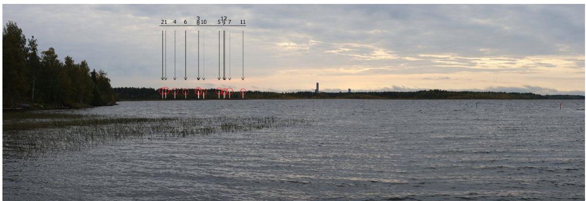
Kuva 64 Havainnekuva 22_1 vaihtoehdossa VE3. Pääosin metsän taakse jäävät voimalat on tuotu näkyviin metsän eteen ja numeroitu. Kuvan keskellä näkyy Ruotasen kaivostorni Pyhäjärven rantamaisemien maamerkinä. Etäisyys lähimpään voimalaan n. 16,5 km.
