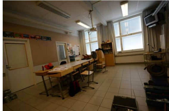
Kuva 63, Luokka 101, entiset muovimatot on kosteusongelmien takia vaihdettu laattaan.
