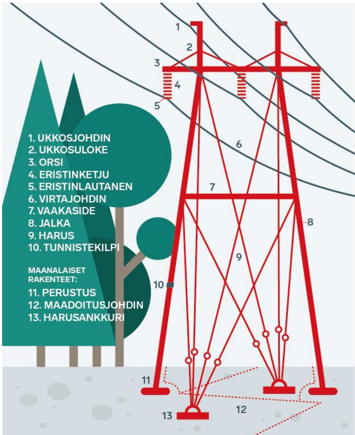
Kuva 6-5. Voimajohdon osat (Fingrid 2022).
